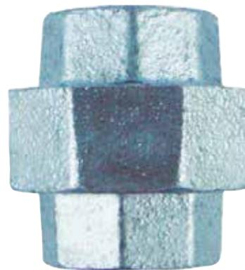
**Verschraubung Nr. 341**, einerseits Innengewinde, andererseits Außengewinde, verzinkt, konisch dichtend
